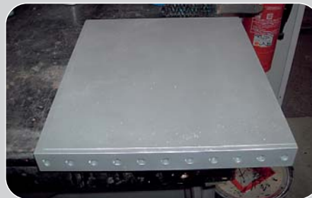
Nach Entfernen der Heizpatronen wird die Platte mit Glasperlen im Sandstrahl-Gebläse gereinigt. (Abb. Links) Danach erfolgt die erste Beschichtung, welche gleichzeitig die Grundierung ist. (Abb. Rechts)
